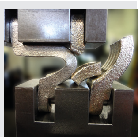
Abstand: 23 mm (kein Riss bei der LUDECKE -Schlauchklemme – vollständig zerstörtes Fremdprodukt)
