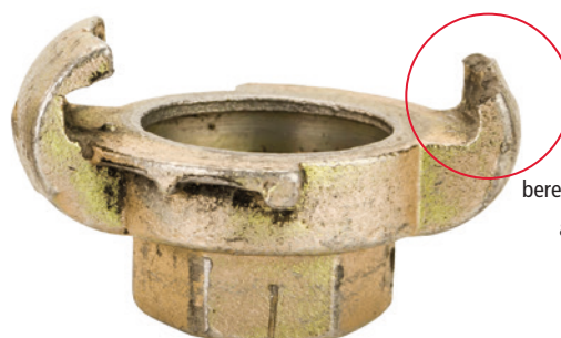
Plagiat aus Fernost (kein Herstellerkennzeichen, minderwertiges Material)
