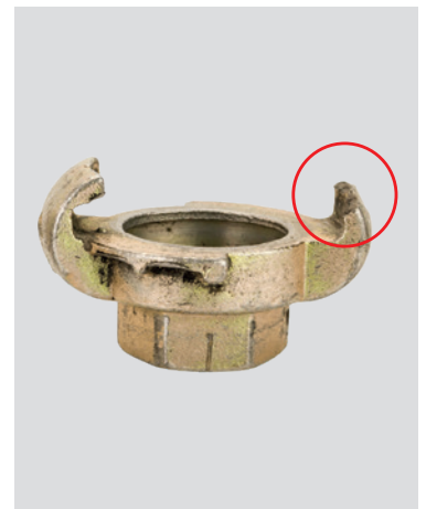
Plagiat aus Fernost mit abgerissener Klaue (kein Herstellerkennzeichen, minderwertiges Material)
